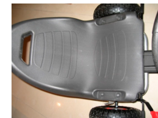
6. Встановіть та закріпіть сидіння гвинтами 5x45. Ви можете вибрати з двох положень сидіння.
